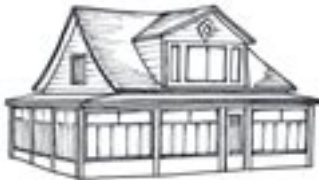
Figure 46 Exemple d'une lucarne disproportionnée pour le volume de la maison.
